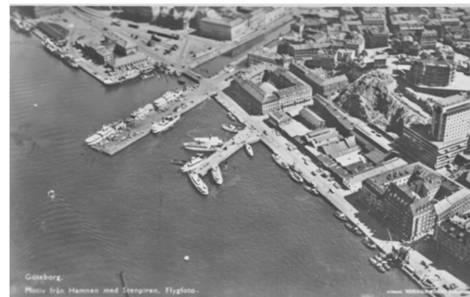
Flygfoto från år 1934 som visar Stenpiren, ångbåtsbryggan och Packhusplatsen. Notera särskilt järnvägsspåret som är framdragna längs kajerna och som givit kajskjul 8 dess säregna form. (Vykort)
